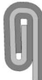
Figura 4 – Tripla Recravação. Fonte: WESSELY et al. (1969)
