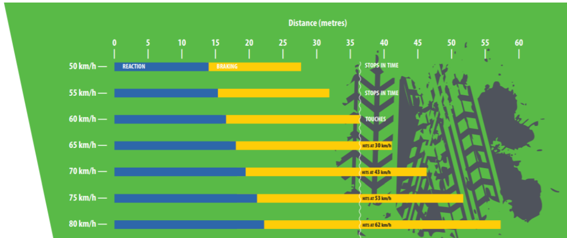
Figura 1 – Distância de frenagem por velocidade (considerando o tempo de reação de 1 segundo).
